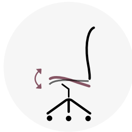
Meccanismo con fulcro avanzato Mechanism with advanced fulcrum Mécanisme désaxé avec pivot avancé Mechanik mit vorn liegender Drehachse Mecanismo con fulcro avanzado
